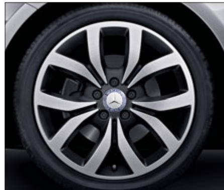
Легкосплавный колесный диск AMG с 5 двоянными спицами, матово-черный, полированный, шины 225/40 R 18 (опция, код R10).
