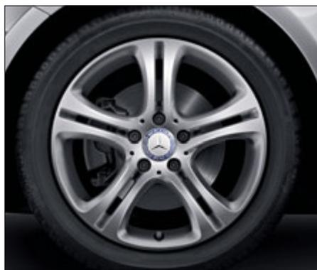
Легкославный колесный диск с 5 сдвоенными спицами, шины 225/45 R 17 (серийно с линией Urban, код R11).
