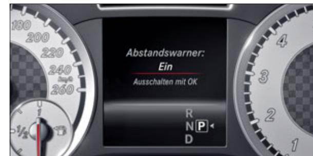
COLLISION PREVENTION ASSIST регистрирует сокращение безопасной дистанции и предупреждает об этом водителя.
