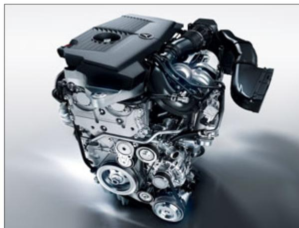
4-цилиндровый бензиновый двигатель А 180 с непосредственным впрыском при помощи пьезоинжекторов и турбонаддувом.
