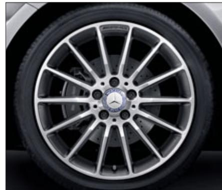
Легкосплавный многоспицевый колесный диск AMG, «Серый титан», полированный, шины 225/40 R 18 (серийно в сочетании с линией AMG Line, код 791).
