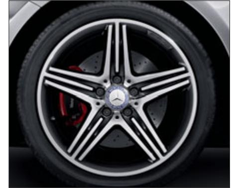
Легкосплавный колесный диск AMG с 5 спицами, черный, полированный, шины 235/40 R 18 (серийно для A 250 Sport и A 250 Sport 4MATIC, код 774).
